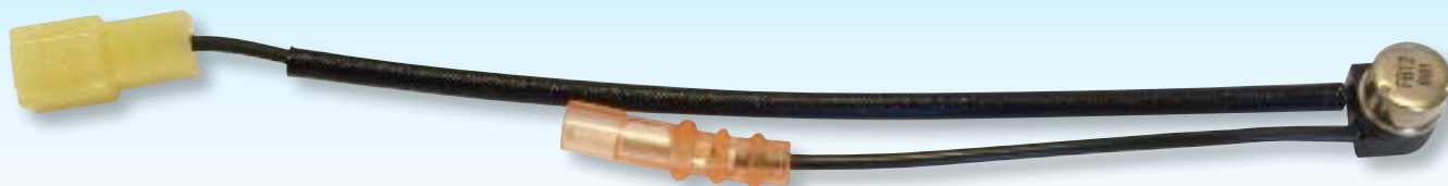
温度感应器适合用於铝制後出大尺寸管接头 (32308-000760) 设置为 85°C 断开 - 65°C连接 53101-000110
