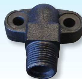
温度感应器适合用於铝制後出大尺寸管接头 (32308-000760) 设置为 85°C 断开 - 65°C连接 53101-000110
