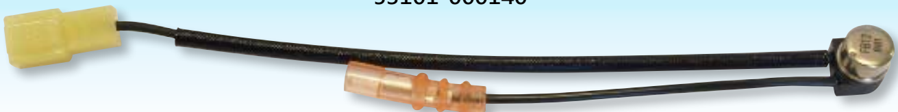
温度感应器适合用于高压注气阀 (38101-000130) 设置为 95°C 断开 - 75°C 连接 53101-000140
